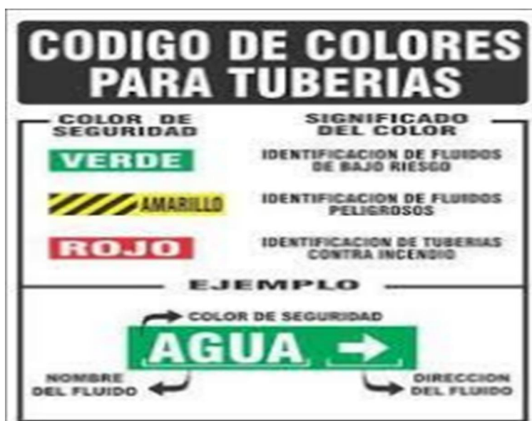
Figura 25. Tipo de señalización en tuberías.
