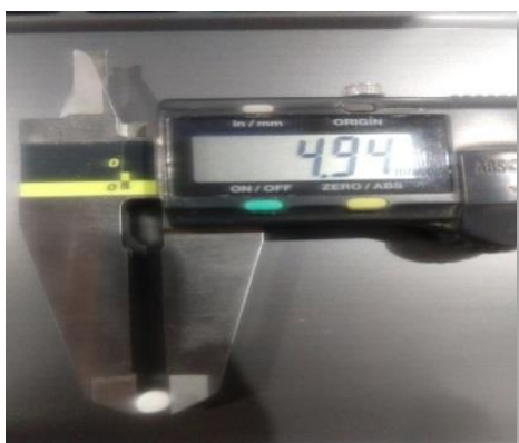
Imagen 7 Medición de Diámetro Grano PVC
