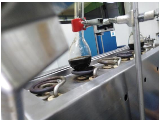
figura 17. Matraz Kjeldahl con muestra.
