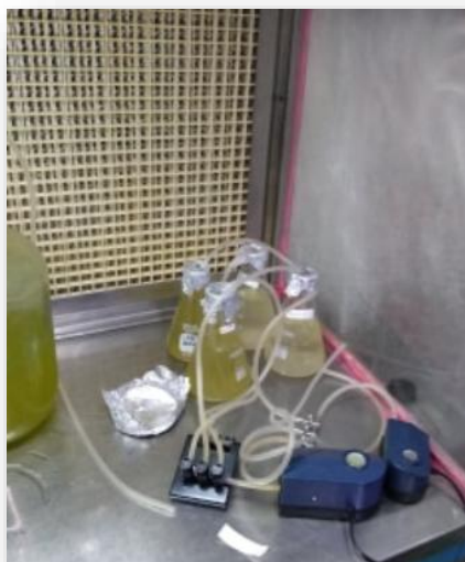
Figura 10 Microalga bajo condiciones de luz y aireación en la campana para la medición de la absorbancia
