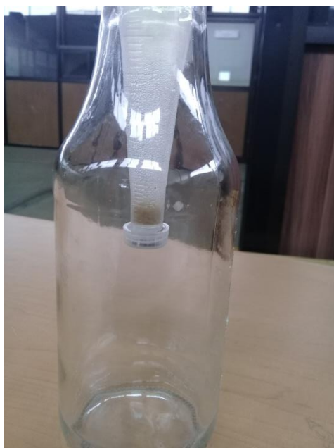
Figura 4.6. Sedimentación del medio (agua residual) previo a la ejecución de la técnica de biorremediación.
