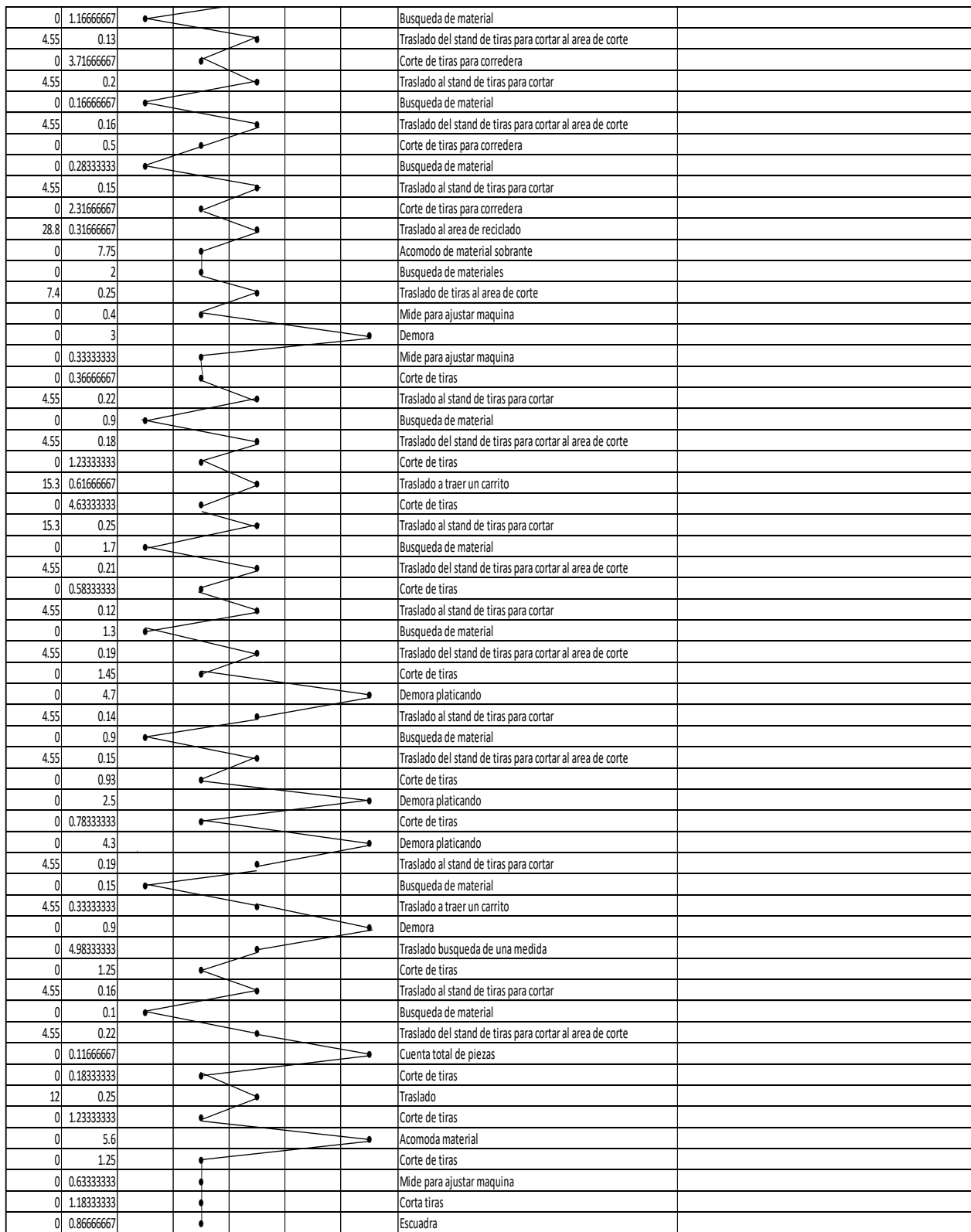
Ilustración 10 tercera parte del diagrama de flujo de proceso del corte de tiras del operador Mario
