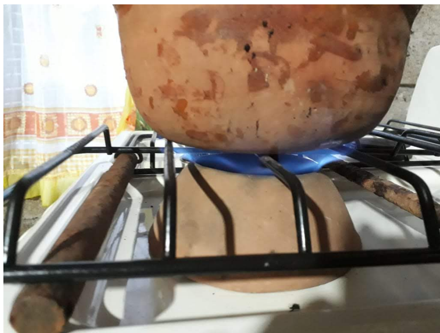
Ilustración 12. Toma de muestra con recipiente de barro y dispositivo ahorrador de gas.
