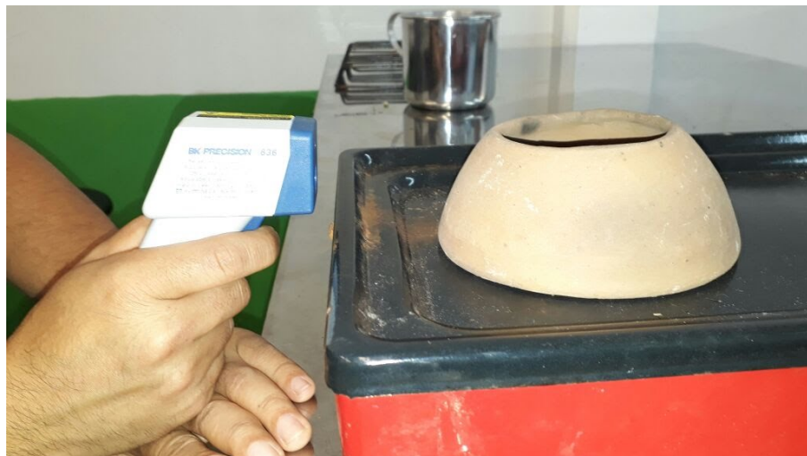
Ilustración 11. Toma de retención de calor en dispositivo ahorrador de gas, mediante termómetro digital (Industrial).
