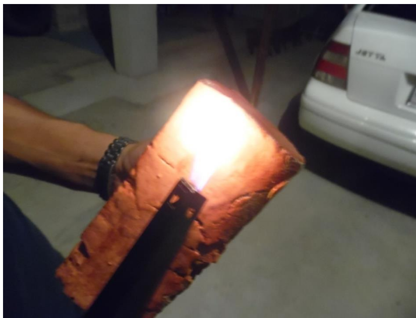
Figura 43. Prueba de aplicación de fuego en el ladrillo sobre el impermeabilizante comprobando que no es inflamable después del secado.
