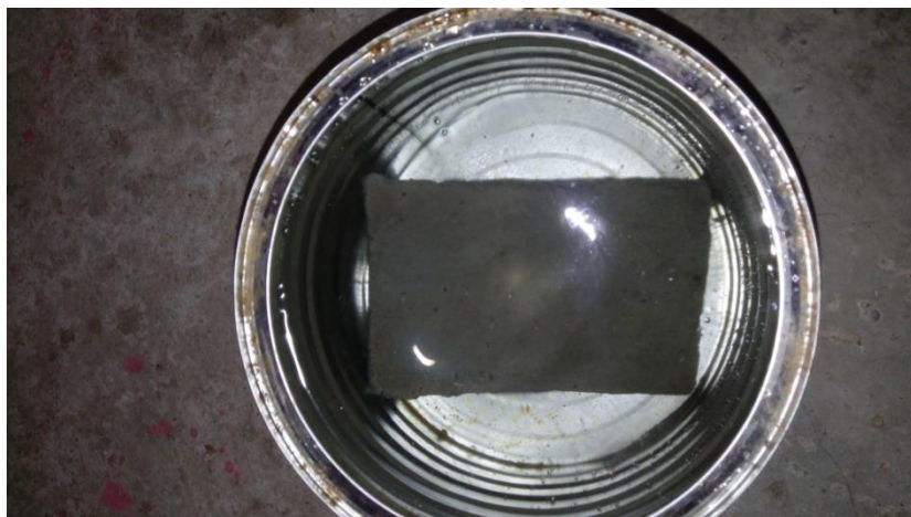
Figura 54. Placa de cemento sumergida en agua.
