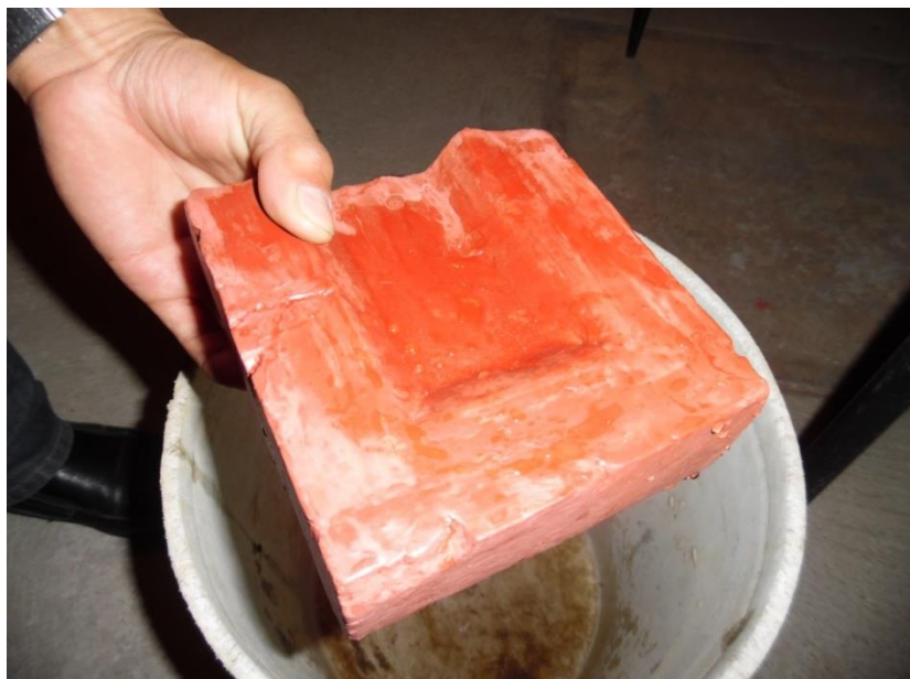
Figura 42. Prueba de aplicación de agua en el ladrillo sobre el impermeabilizante.
