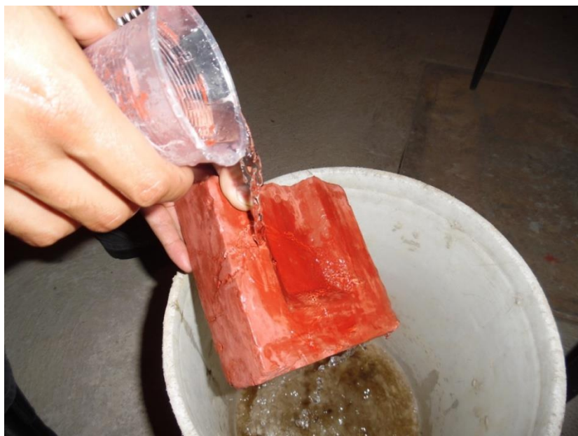
Figura 41. Prueba de aplicación de agua en el ladrillo sobre el impermeabilizante.
