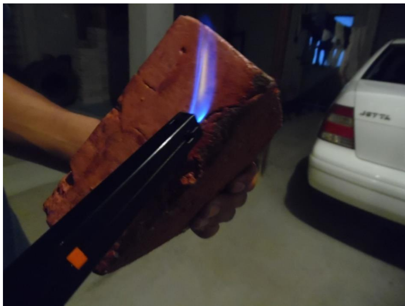
Figura 44. Prueba de aplicación de fuego en el ladrillo sobre el impermeabilizante comprobando que no es inflamable después del secado.
