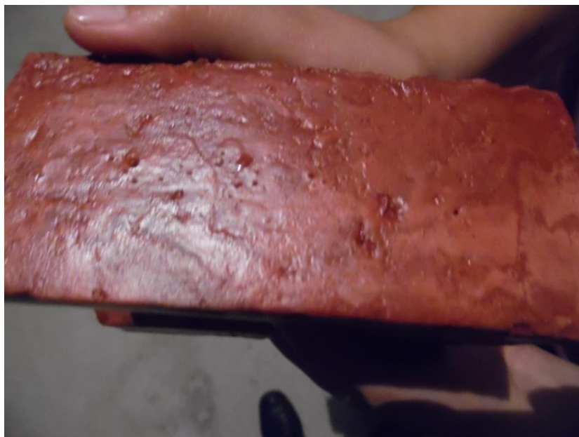
Figura 46. Prueba de aplicación de fuego en el ladrillo sobre el impermeabilizante comprobando que no es inflamable después del secado.
