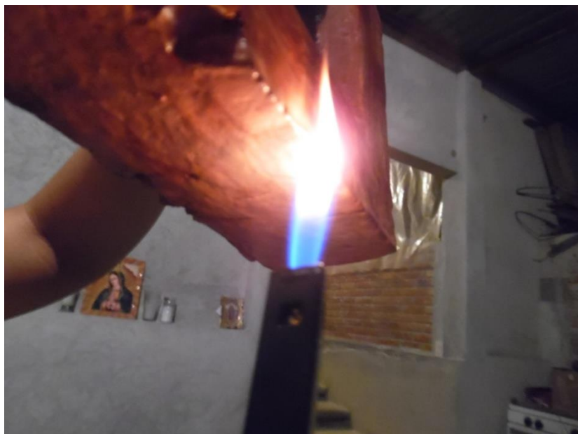
Figura 45. Prueba de aplicación de fuego en el ladrillo sobre el impermeabilizante comprobando que no es inflamable después del secado.
