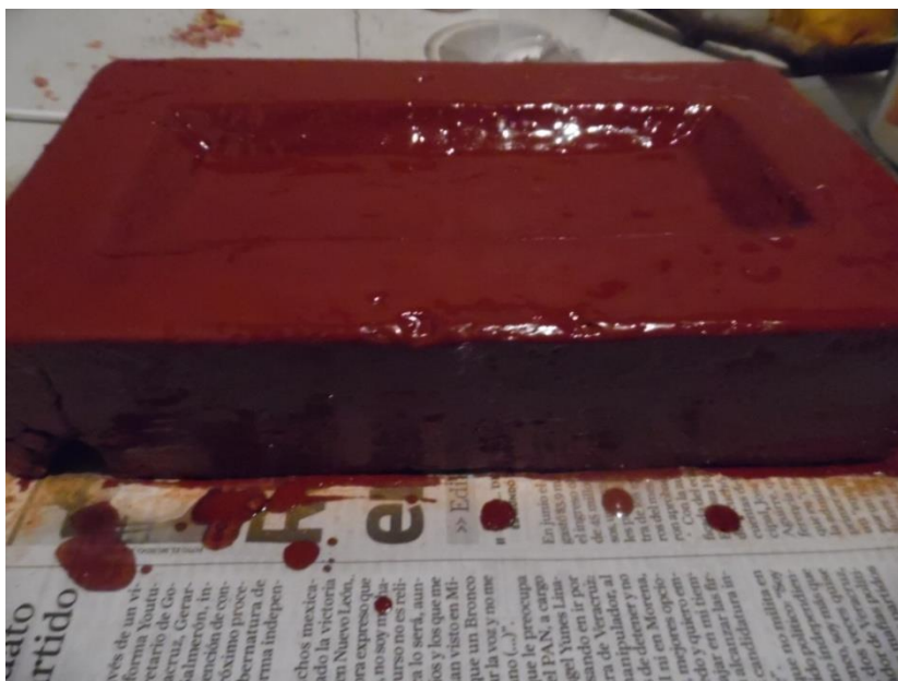
Figura 36. Aplicación del impermeabilizante a un ladrillo.
