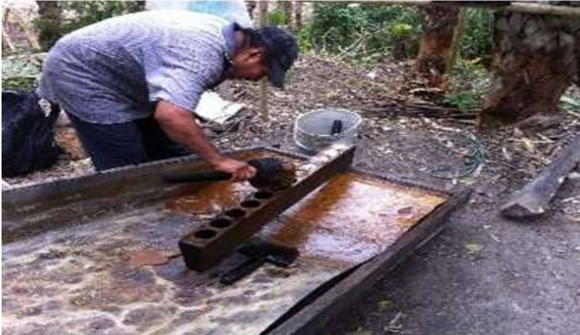
Figura 6 Detección del punto de cristalización.
