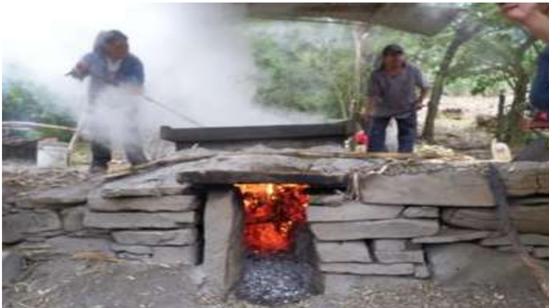
Figura 7 Evaporación y moldeado del piloncillo.
