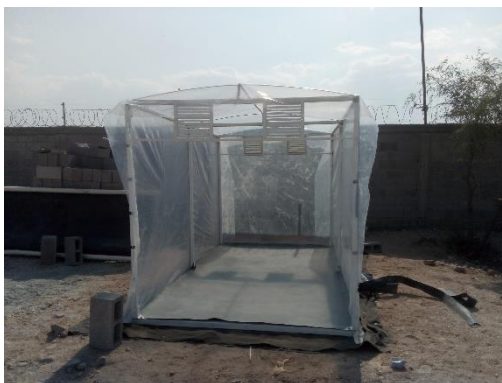
Ilustración 32. secado por medio de radiación solar mediante un invernadero.
