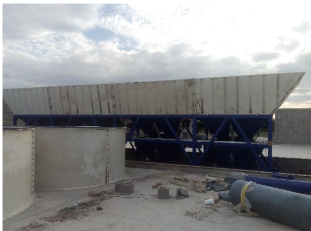
Ilustración 45. Tolvas de almacenamiento de residuo.
