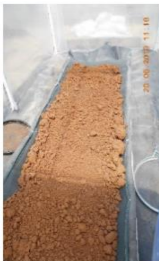
Ilustración 30. secado de lodo por método de radiación solar.
