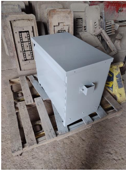
Figura 10. Transformador seco restaurado
