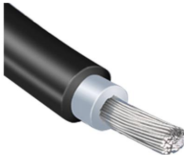
Figura 25. Cable fotovoltaico de cobre estañado con 56 hilos de alta flexibilidad y doble aislamiento XLPE.
