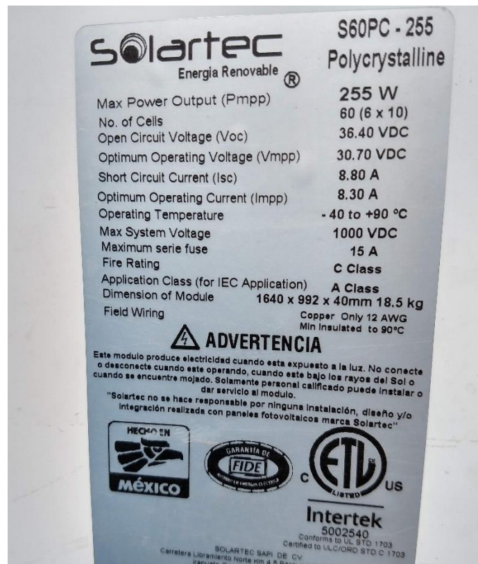
Figura 13. Ficha técnica de un módulo FV o panel solar poli-cristalino de 255 W de la marca Solartec®.
