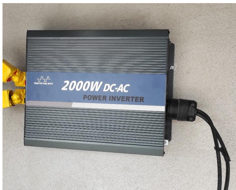
Figura 30. Inversor para sistema autónomo.
