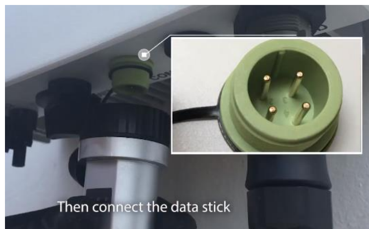
Figura 88. Conexión de la antena de monitoreo Wi-Fi.
