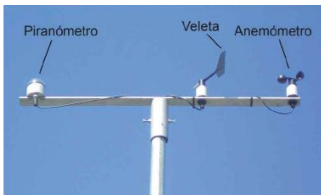
Figura 28 Dispositivos de medida de una estación
