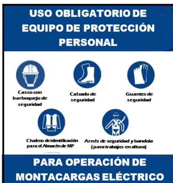
Ilustración 3.6 Señalética EPP para operación de montacargas eléctrico
