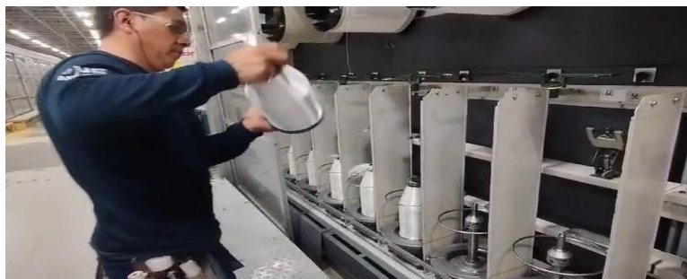
Ilustración 25 Operador descargador inspeccionando el defecto cóncavo en bobinas
