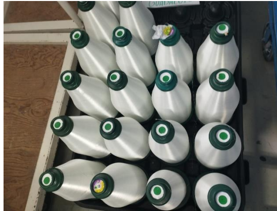
Ilustración 31 Bobinas con defecto cóncavo
