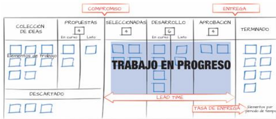
Ilustración 11. Ejemplo de tablero Kanban
