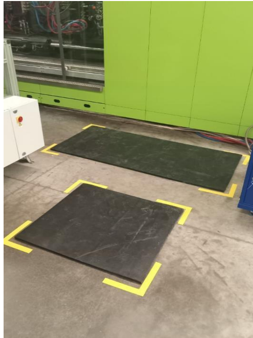
Ilustración 24. Delimitación de áreas y colocación de neopreno. (BM Plastic. 2024)
