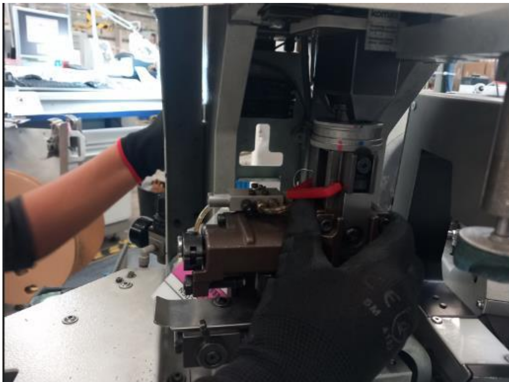
Figura 13.1 Pre-ajuste de aplicador por parte de operador
