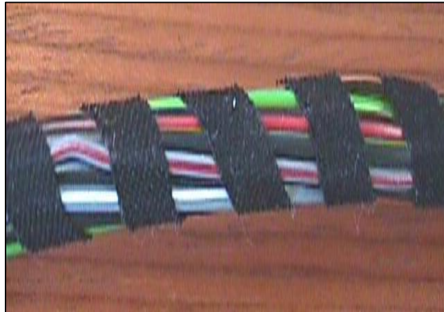
Figura Encintado En Espiral y el encintado alterno solo da forma a los circuitos donde la carrocería no puede dañar directamente el ramal.
