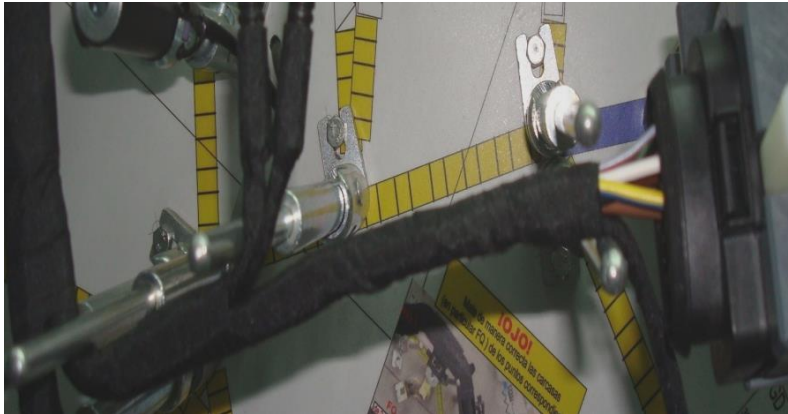
Figura Encintado Continuo este protege a los circuitos de las zonas donde la carrocería del auto puede dañar estos componentes.
