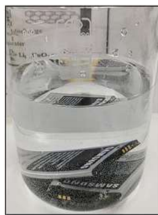
Figura 3.10 Descarga de baterías en disolución de NaCl
