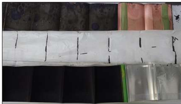
Figura 3.11 BIL desarmada donde de arriba hacia abajo puede verse: ánodo, separador y cátodo.
