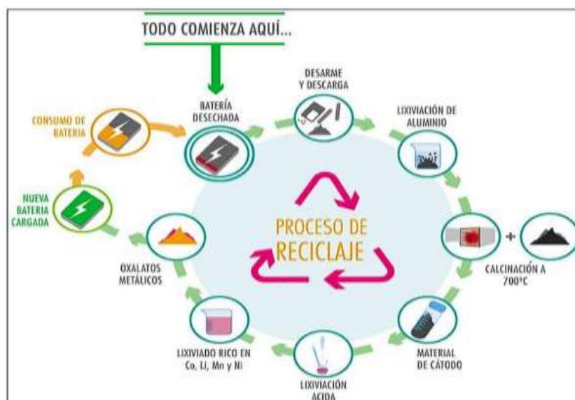
Figura 3.9 Esquema del modelo de reciclaje
