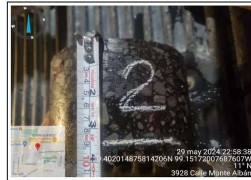
Fig. 4. Extracción de núcleo para verificación de espesor y compactación en Casa del obrero mundial
