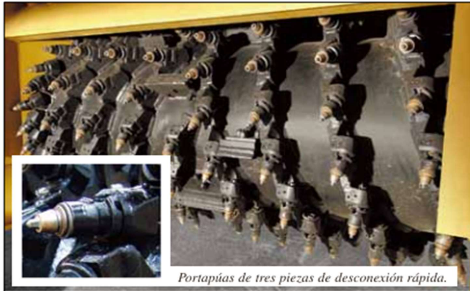
Figura 40 Rotor con porta púas cónico, CATERPILLAR
