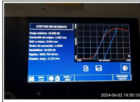
Fig. 8. Determinación de estabilidad Marshall
