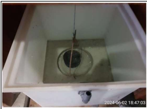
Fig. 7. Determinación de gravedad específica en núcleos de pavimentos
