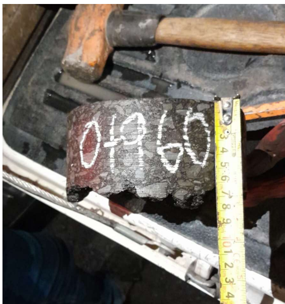
Figura 61 Espesor del corazón extraído en el cadenamiento 0+960, FRAGUA INGENIEROS
