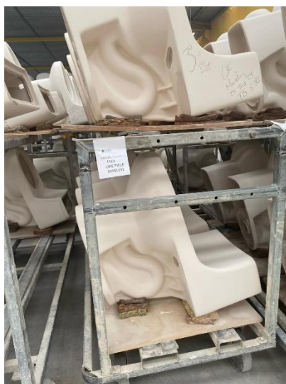
Ilustración 36 Colocación de Formato One Piece en Carros de producción
