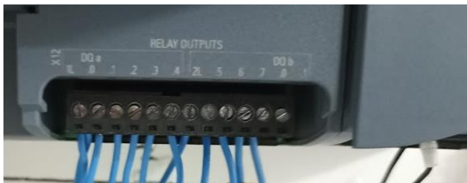
Figura 34 Imagen Salidas del PLC
