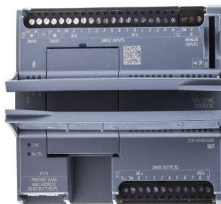
Figura 4 PLC Siemens 1215c
