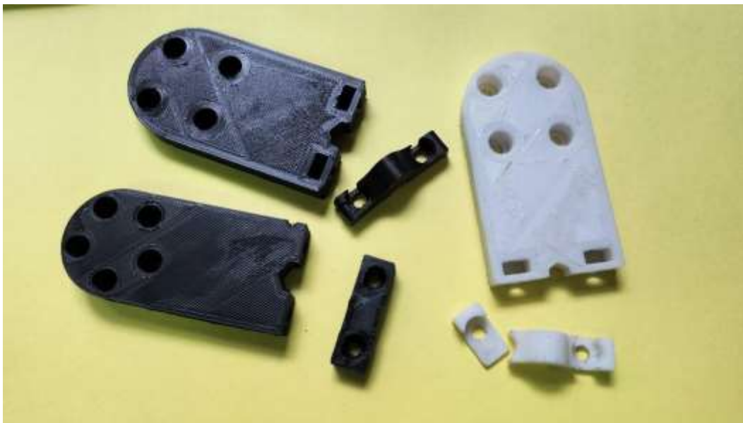
Ilustración 41 Impresiones sujetador de ventosa, fallos
