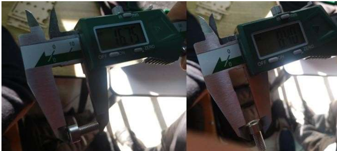
Ilustración 28 Toma de medidas del tornillo M5
