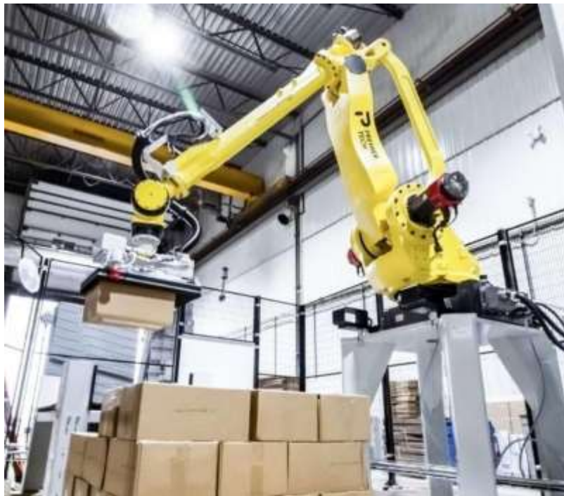
Ilustración 18 Robot Paletizador Nivel básico CHRONOS RPL-1000 SERIES
