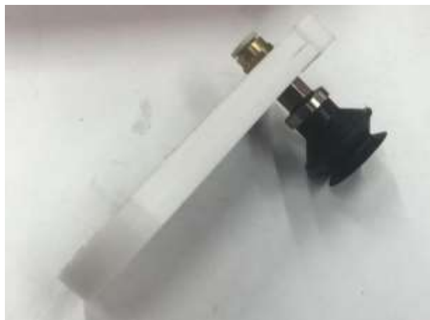
Ilustración 51 Sujetador de ventosa y ventosa montada
