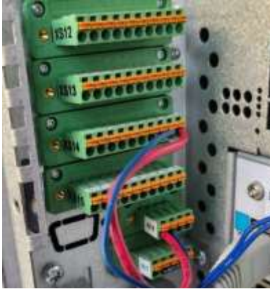
Ilustración 70 Entradas y Salidas IRC5 Compact
