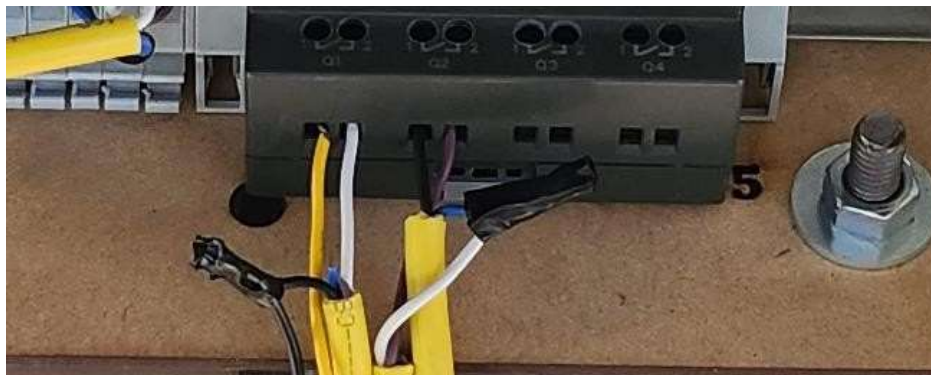
Ilustración 76 Conexiones físicas de salidas Q1 Y Q2
