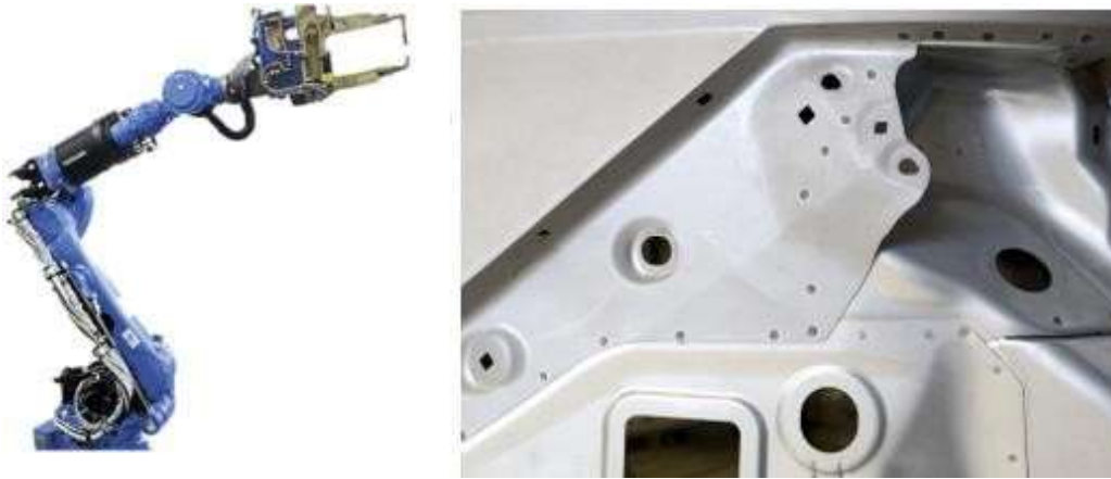
Ilustración 16 Robot soldador por puntos y puntos de soldadura
