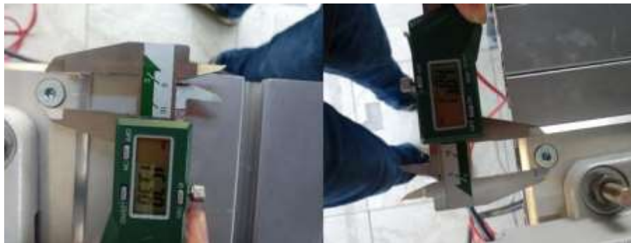
Ilustración 26 Toma de medidas tornillos de sujeción
