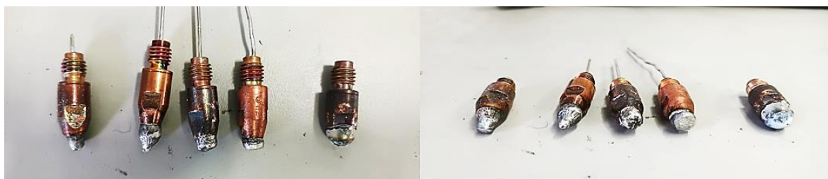
Figura 5. 92 Puntas de contacto en donde el microalambre fundido se solidifico internamente.
