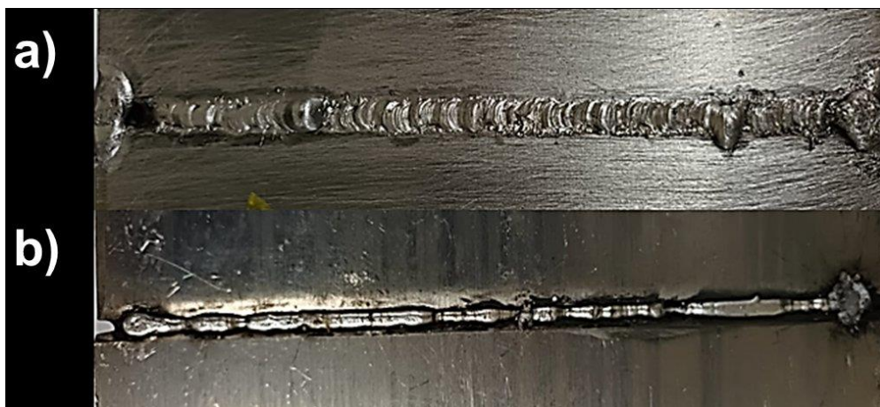
Figura 5. 55 Soldadura 21 empleando 39 volts, 258 velocidad de hilo, 0.4 velocidad de robot, 2 stick out y 1 abertura de raíz del segundo diseño de experimentos. En donde a) vista superior y b) vista inferior.
