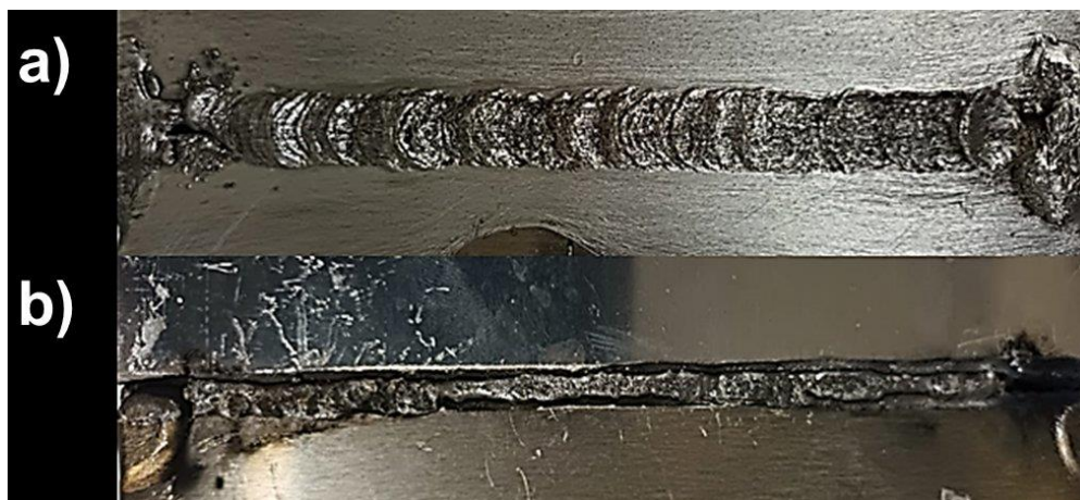
Figura 5. 60 Soldadura 33 empleando 39 volts, 359 velocidad de hilo, 0.4 velocidad de robot, 2 stick out y 3 abertura de raíz del diseño de experimentos actualizado. En donde a) vista superior y b) vista inferior.
