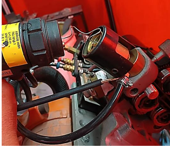
Figura 5. 93 Microalambre enredado internamente.
