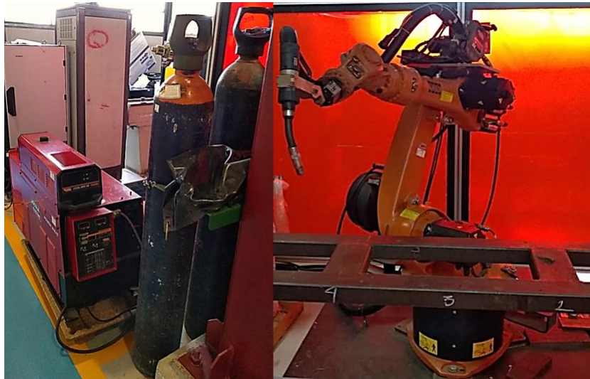
Figura 3. 2 Robot soldador disponible en la celda de manufactura en COMIMSA.
