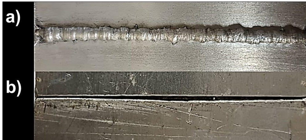
Figura 5. 52 Soldadura 21 empleando 30 volts, 250 velocidad de hilo, 0.4 velocidad de robot, 2 stick out y 0 abertura de raíz del primer diseño de experimentos. En donde a) vista superior y b) vista inferior.
