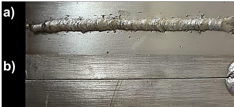
Figura 5. 51 Soldadura 1 empleando 24 volts, 350 velocidad de hilo, 0.4 velocidad de robot, 1.5 stick out y 0 abertura de raíz del primer diseño de experimentos. En donde a) vista superior y b) vista inferior.
