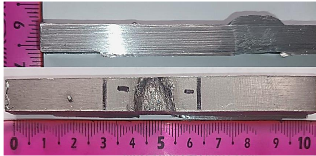
Figura 5. 62 Ejemplo representativo del tramo del cordón de soldadura.
