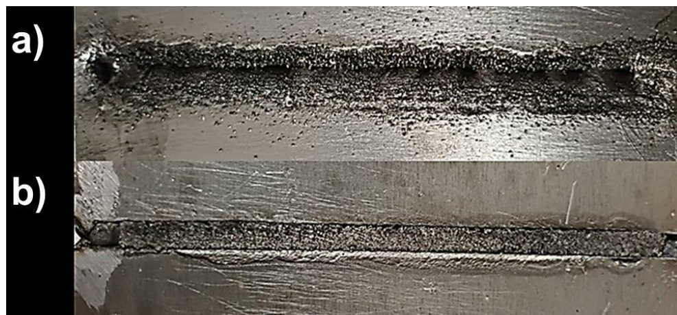
Figura 5. 58 Soldadura 33 empleando 30 volts, 350 velocidad de hilo, 0.4 velocidad de robot, 2 stick out y 5 abertura de raíz del primer diseño de experimentos. En donde a) vista superior y b) vista inferior.
