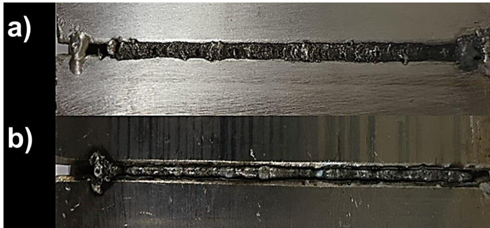
Figura 5. 59 Soldadura 16 empleando 39 volts, 258 velocidad de hilo, 0.4 velocidad de robot, 2 stick out y 3 abertura de raíz del diseño de experimentos actualizado. En donde a) vista superior y b) vista inferior.
