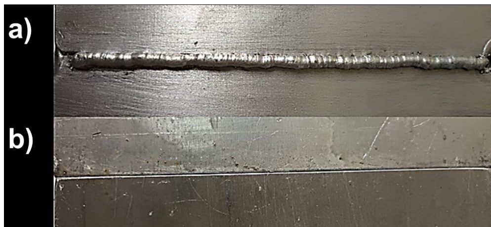
Figura 5. 53 Soldadura 30 empleando 24 volts, 250 velocidad de hilo, 0.6 velocidad de robot, 1.5 stick out y 0 abertura de raíz del primer diseño de experimentos. En donde a) vista superior y b) vista inferior.
