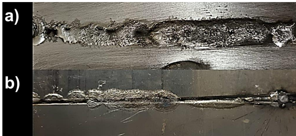
Figura 5. 54 Soldadura 1 empleando 33 volts, 359 velocidad de hilo, 0.4 velocidad de robot, 1.5 stick out y 1 abertura de raíz del segundo diseño de experimentos. En donde a) vista superior y b) vista inferior.
