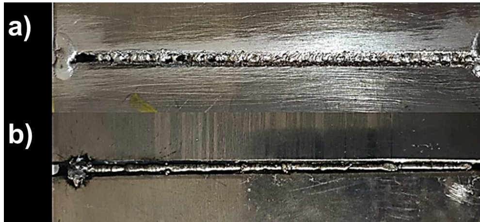
Figura 5. 56 Soldadura 30 empleando 33 volts, 258 velocidad de hilo, 0.6 velocidad de robot, 1.5 stick out y 1 abertura de raíz del segundo diseño de experimentos. En donde a) vista superior y b) vista inferior.
