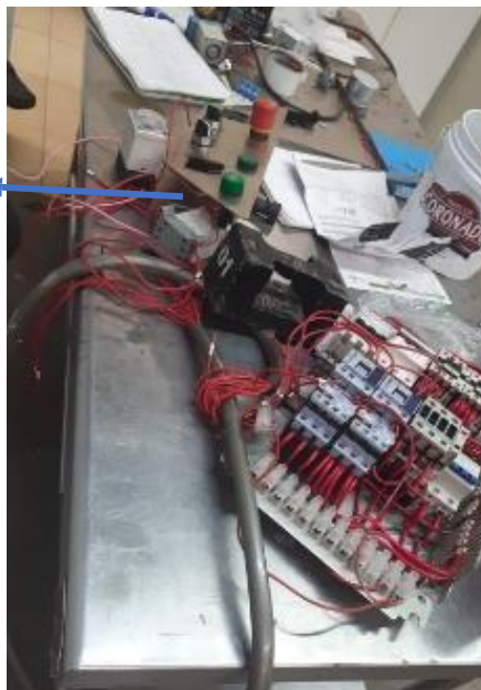
Panel de Mando con botoneras S, S1 , selectores S2 y S3 e indicadores H1, H2
