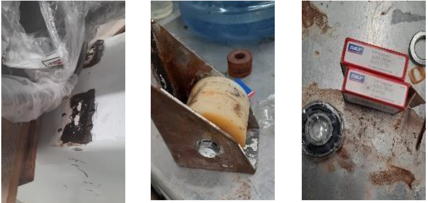
Figura 27. Cambio de rodamientos de ruedas auxiliares (Código Foods, Enero 2023)
