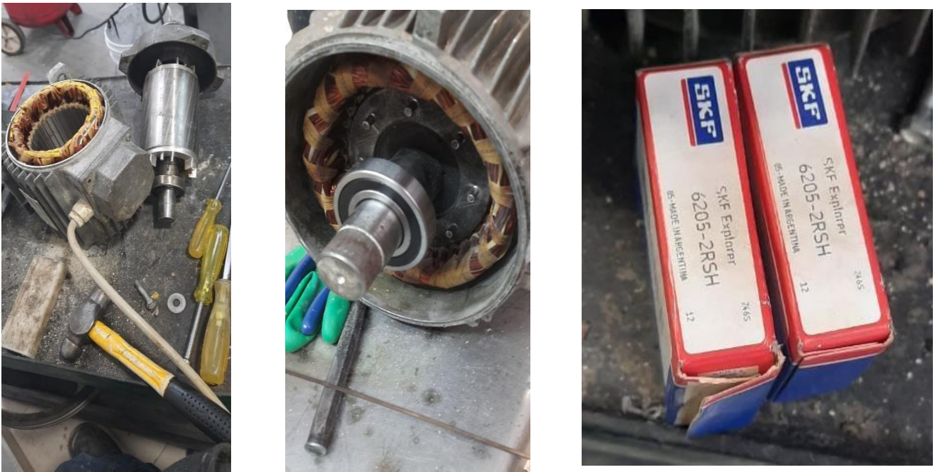
Figura 17. Motores desmontados y refacción de rodamientos. (Código Foods, Noviembre 2022)
