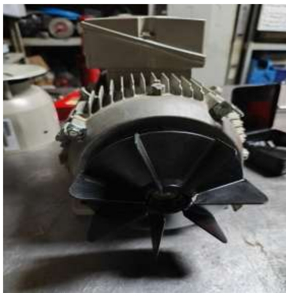
FIGURA 95 Ventilador colocado (Autoría Propia, 2023)
