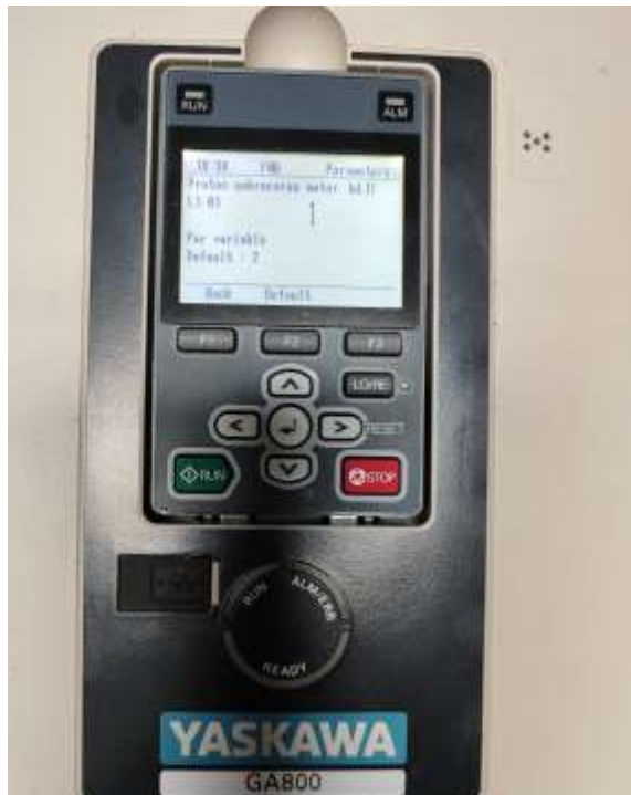
FIGURA 75 L1-01 Protección sobrecarga motor (Autoría Propia, 2023)
