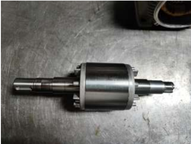
FIGURA 87 Rotor sin baleros (Autoría Propia, 2023)
