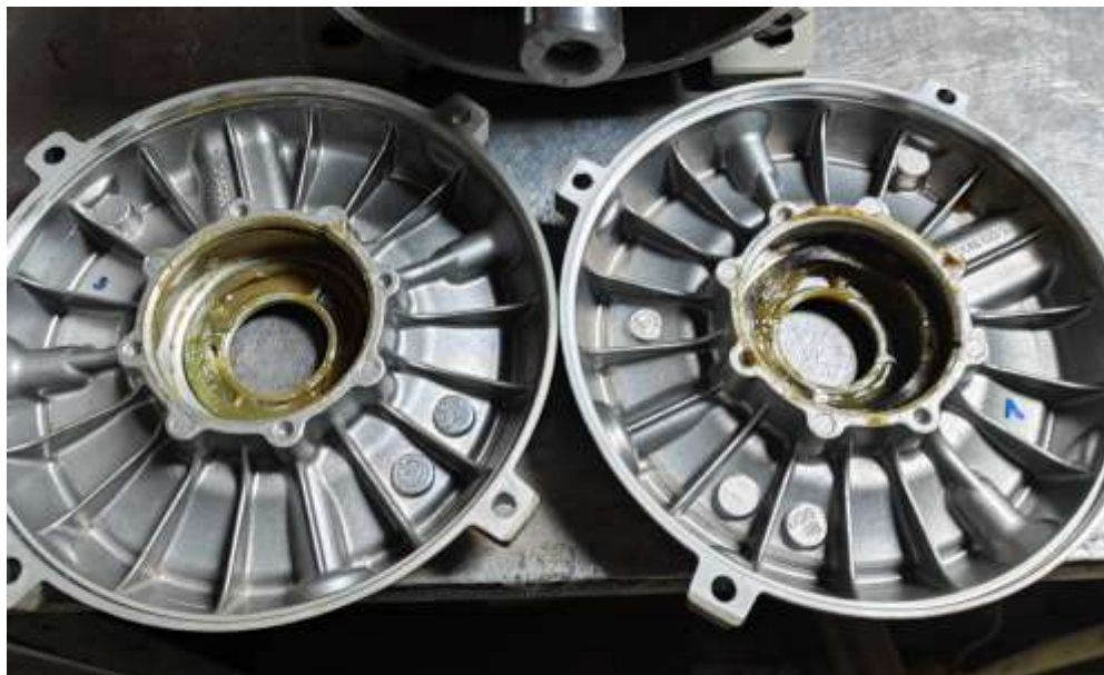
FIGURA 89 Tapas del motor sucias (Autoría Propia, 2023)
