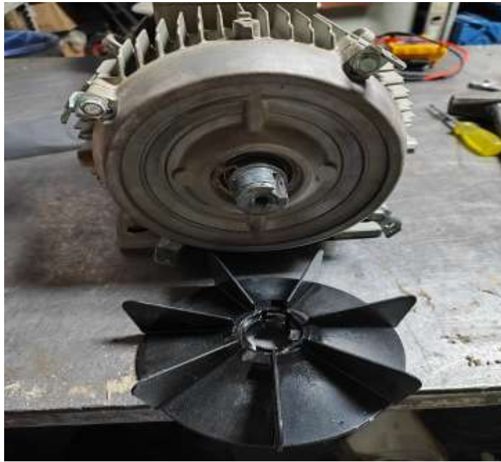
FIGURA 61 Retirar ventilador (Autoría Propia, 2023)
