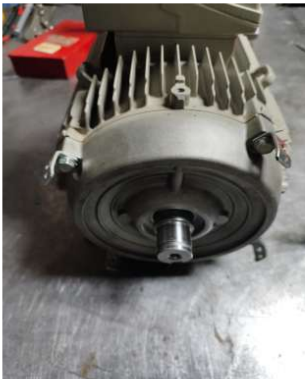
FIGURA 94 Apriete de tornillería (Autoría Propia, 2023)
