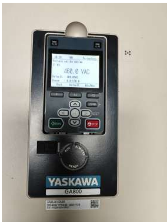
FIGURA 46 E1-05 Voltaje salida máximo (Autoría Propia, 2023)
