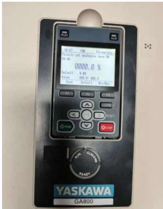
FIGURA 69 H4-03 Polarización salida analógica terminal FM (Autoría Propia. 2023)
