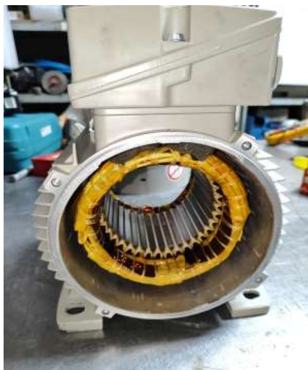
FIGURA 91 Limpieza de embobinado (Autoría Propia, 2023)
