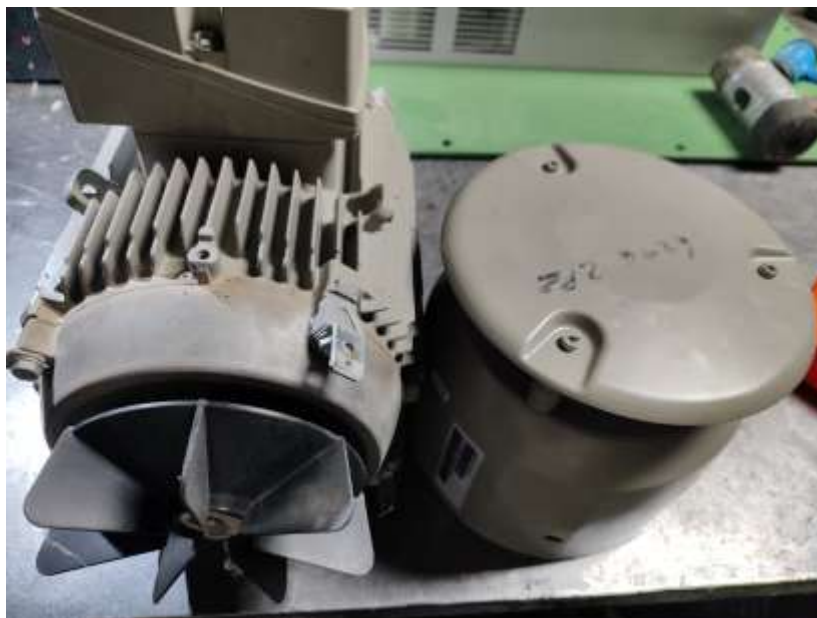
FIGURA 96 Colocar ventilador (Autoría Propia, 2023)
