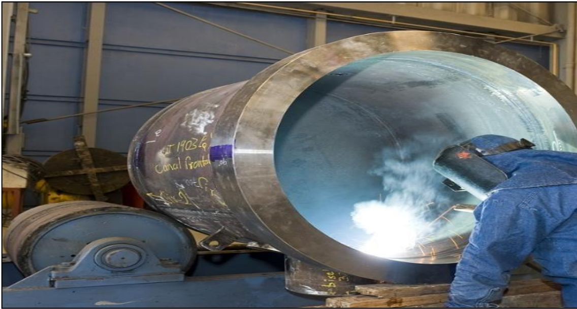
Figura 22: Refuerzo de soldadura para tanque
