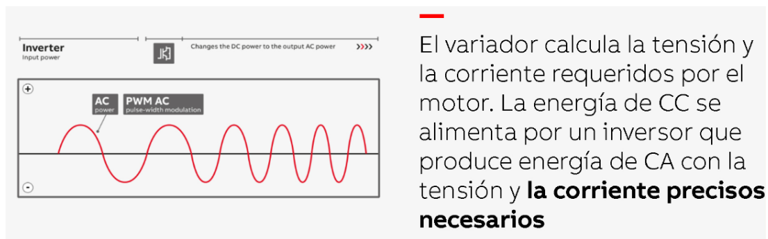
Imagen 39. Convertir la onda CC a la variable de CA. Fuente: ABB VFD. Obtenido de ABB VFD: https://new.abb.com/drives/es/que-es-un-variador
