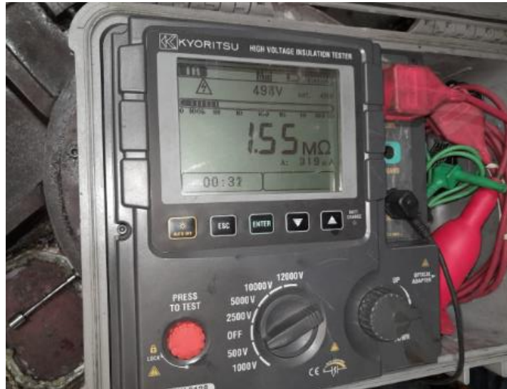
Imagen 109. Megger de la empresa. Fuente: fotografía tomada por estudiante.
