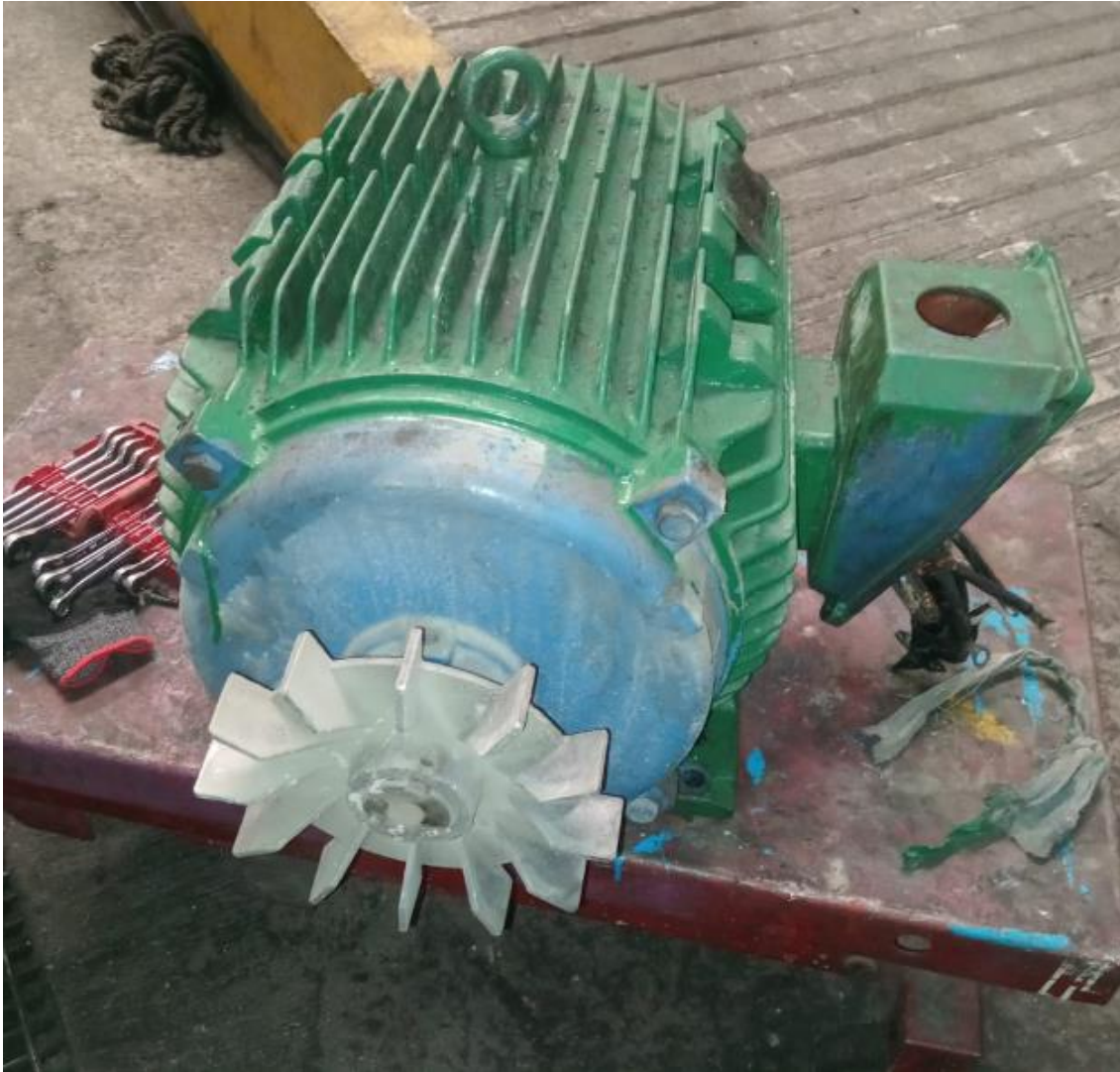
Imagen 128. Desarme de motores de fosa "L-224" (1). Fuente: fotografía tomada por estudiante.
