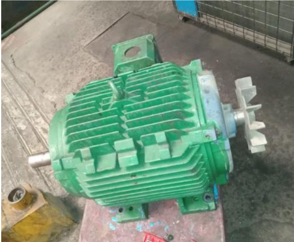
Imagen 130. Desarme de motores de fosa "L-224" (3). Fuente: fotografía tomada por estudiante.
