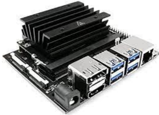
Figura 6. Nvidia Jetson nano sistema embebido de la marca Nvidia. [14]
