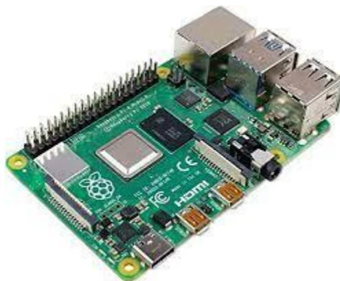
Figura 5. Raspberry pi, sistema embebido más usado. [13]
