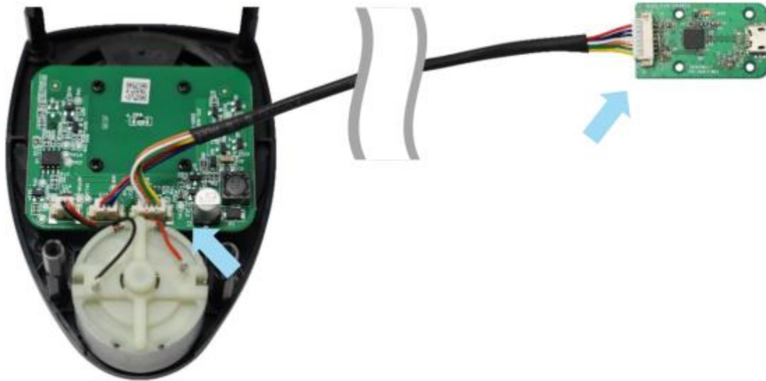
Figura 19. Representación de conexión entre el sensor lidar y el hub.
