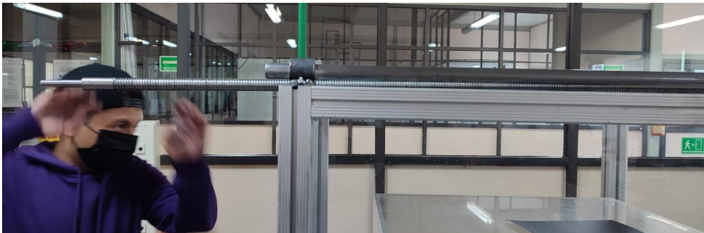
Colocación de flecha sin fin.
