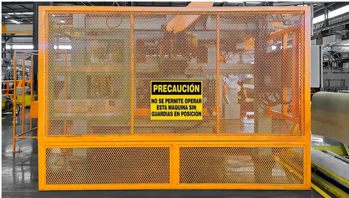
Fig. 18: Guarda de Seguridad en Maquinaria
