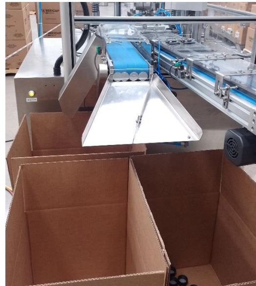
Fig. 30: Transportador de Salida de Tapa Selectora de Liner
