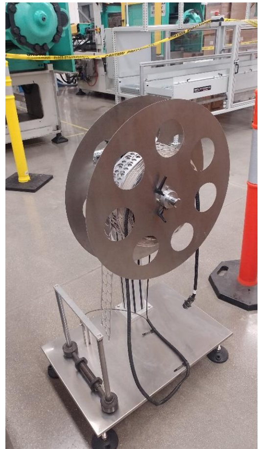
Salida de liner.
