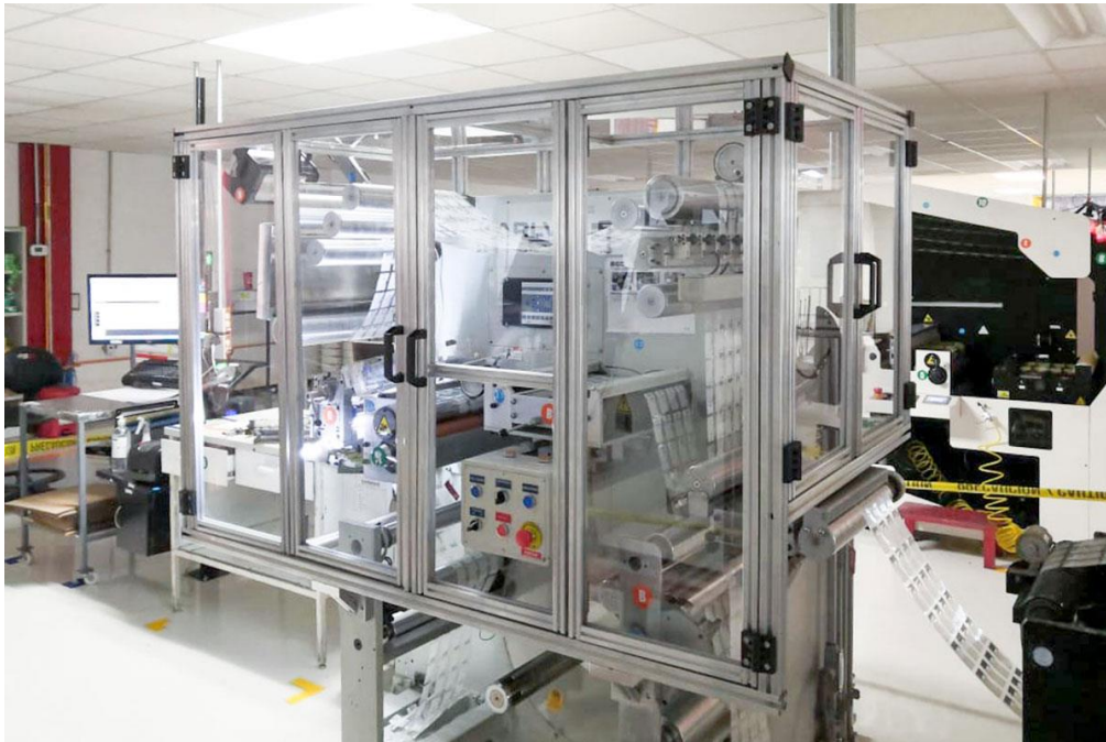
Fig. 17: Guarda de Seguridad
