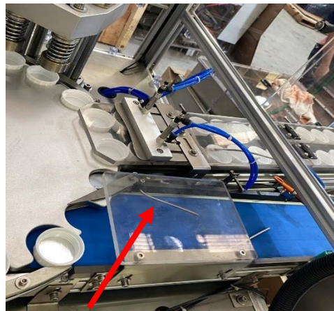
Fig. 52: Túneles de Entrada y Salida de Tapas de Banda Transportadora
