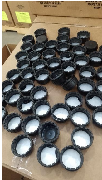
Fig. 54: Tapas con mal colocación de Liner
