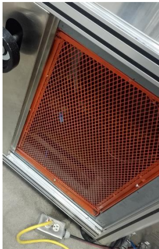
Fig. 45: Incorporación de Mallas Metálicas de Protección
