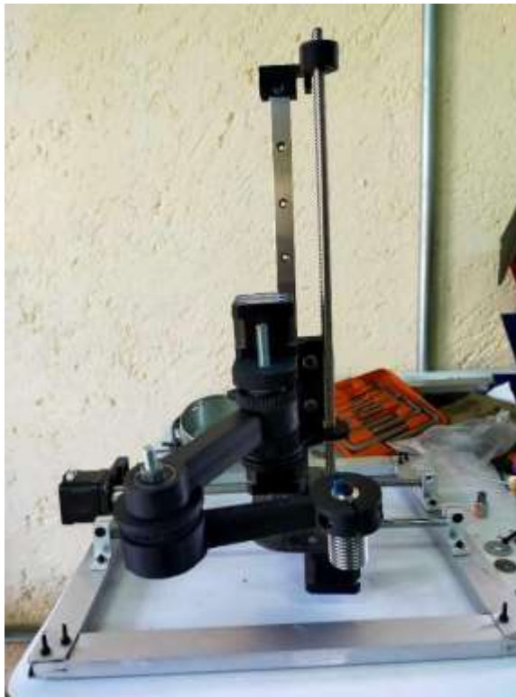
Fig. 3.7.5 colocación de la punta Hotpipe completando así el dispositivo mecánico
