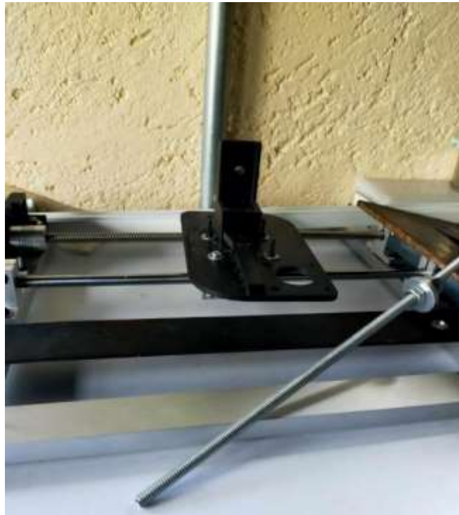
Fig. 3.7.2 construcción de la base deslizable del Scara
