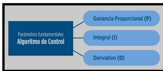
Figura 45. Parámetros fundamentales del PID [92]
