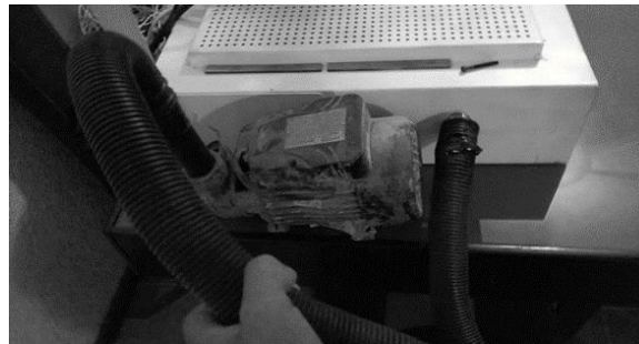
Ilustración 42 Bomba de vacío conectada a la estructura
