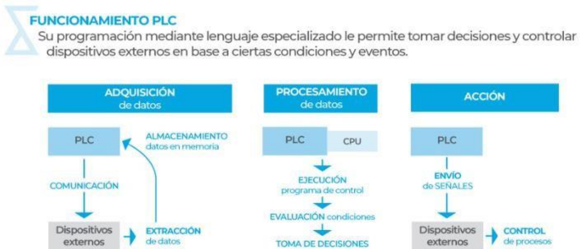
Ilustración 22 Estructura de un PLC
