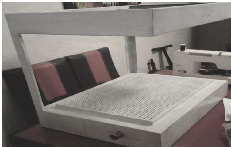
Ilustración 40 Estructura física termo formadora. Desarrollado
