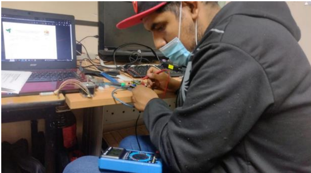
Ilustración 44: Conexión y revisión de motores Nema 23(Fuentes Propias),2023
