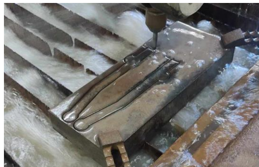
Proceso de corte por chorro de agua.
