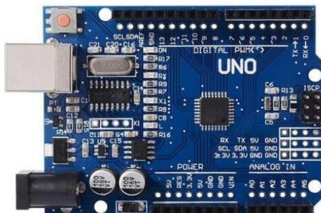
Ilustración 14: Arduino Uno SMD (2011)
