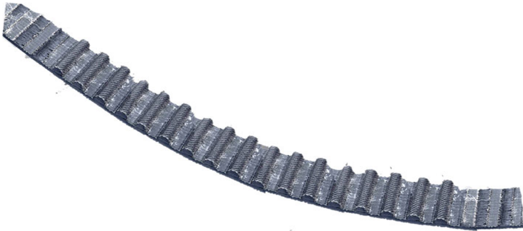
Figura 4.1.10 Banda Polychain con dientes desgajados Foto ilustrativa.
