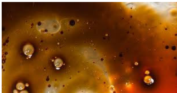
Figura 2.2. A.12 Contaminación del sistema hidráulico.
