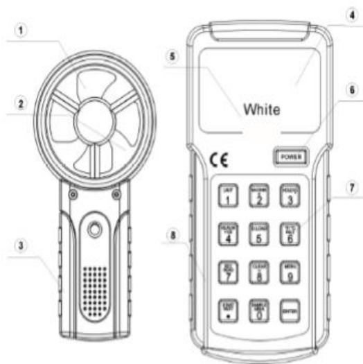
Figura 3-19 Estructura del Anemómetro
