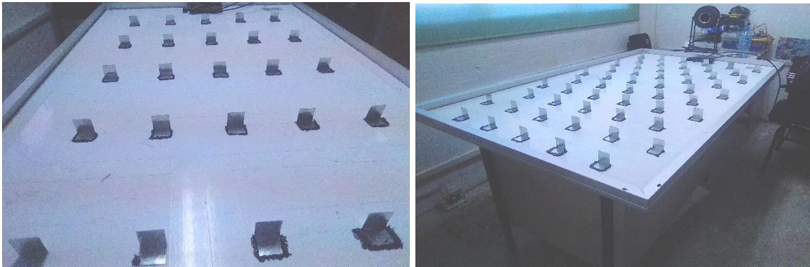
Figura 3-16 Colocación de aletas en panel fotovoltaico.
