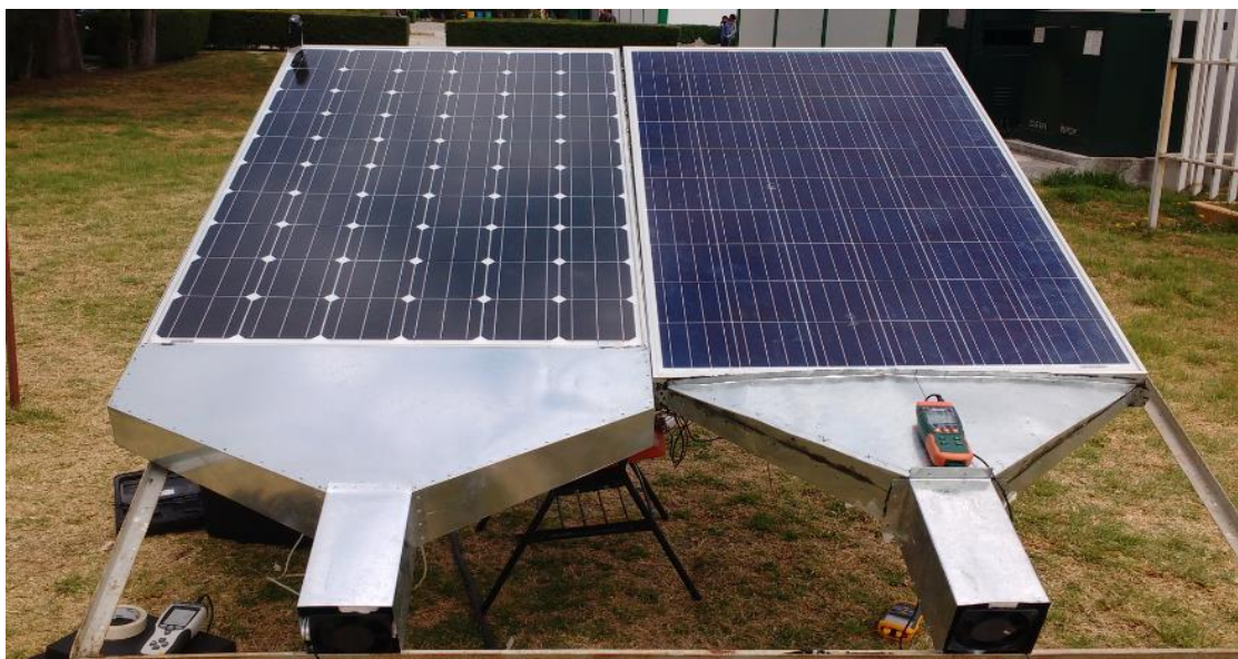
Figura 3-3 Panel policristalino y monocristalino acoplados a un canal (sistema híbrido).
