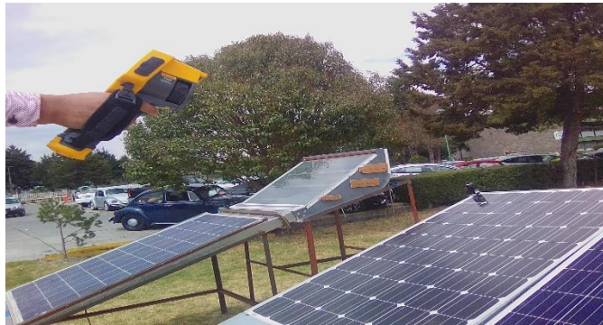
Figura 3-11 Cámara termográfica utilizada en las pruebas experimentales.
