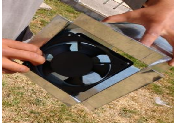
Figura 3-6 Colocación de ventilador en ducto
