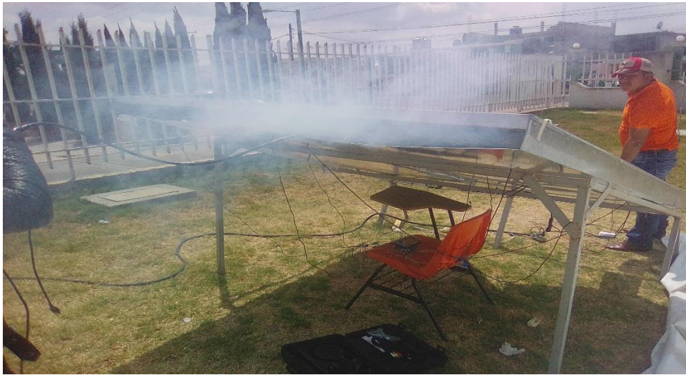
Figura 3-14 Prueba experimental del comportamiento del fluido a través de un canal.
