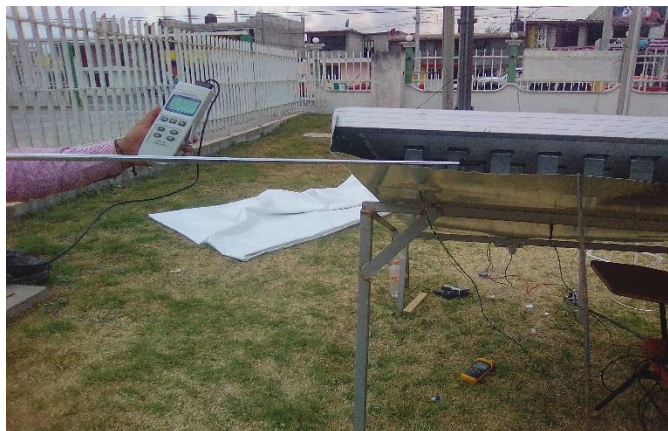
Figura 3-12 Tomando lectura de presión a la salida del canal
