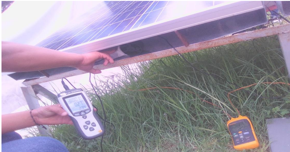
a) Velocidad y temperatura tomada a la entrada del panel
