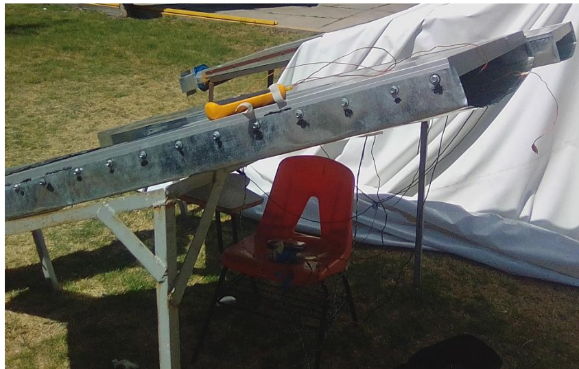
Figura 3-9 Obteniendo temperatura con termómetro en interior de panel.
