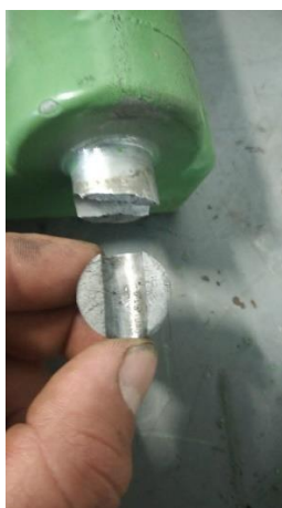
Ilustración 23 Herramienta deteriorada de Torno Romí
