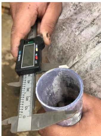
Ilustración 22 Material con medida de diámetro equivocado y material sucio
