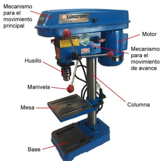
Ilustración 15 Partes de taladro de banco
