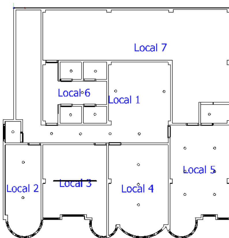
Figura 31 Cuarto nivel (servicios generales) plano de iluminación
