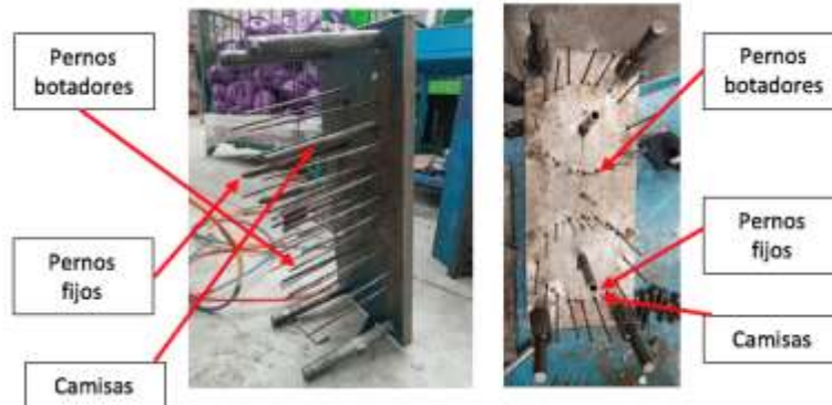
Figura 12: Botadores en molde de inyección.
