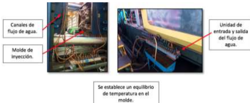
Figura 13: Canales de enfriamiento en el molde.
