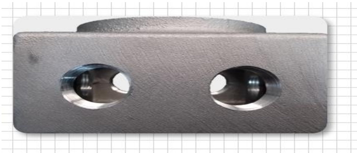
Ilustración 12: Pre-maquinado de pieza Hood [Fuente: cortesía Funhedi, 2023].
