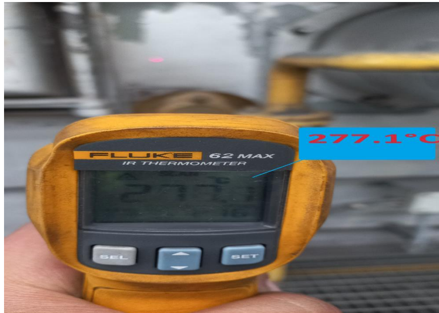
Imagen 17: Temperatura número 6 de la pared de la zona 5, 6 y 7 medida con un pirómetro.
