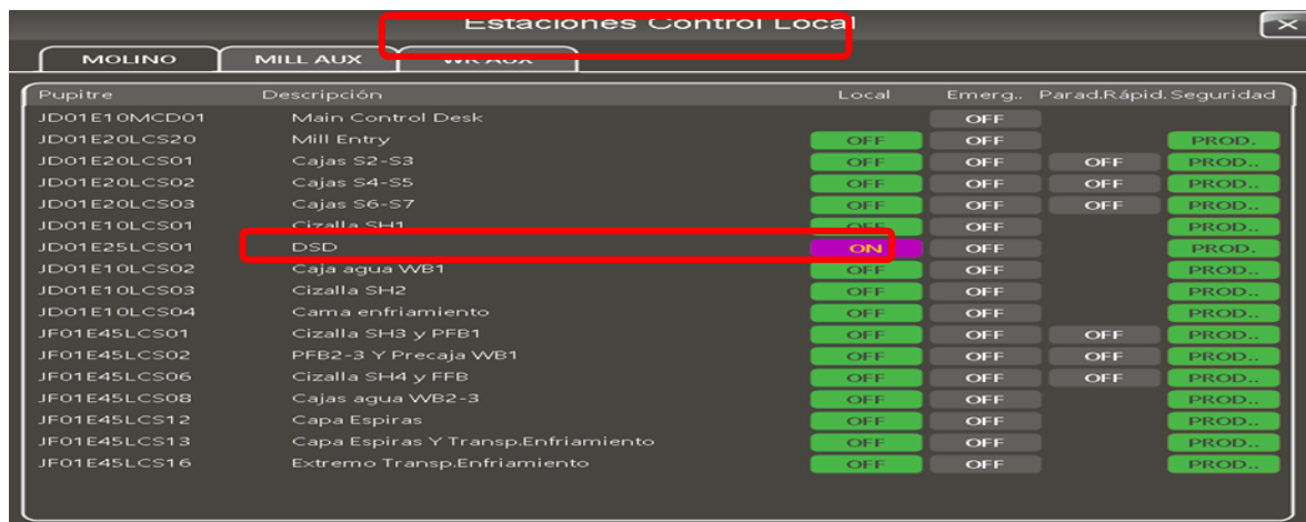
Imagen 31: Ubicación y control local en áreas del tren de laminación
