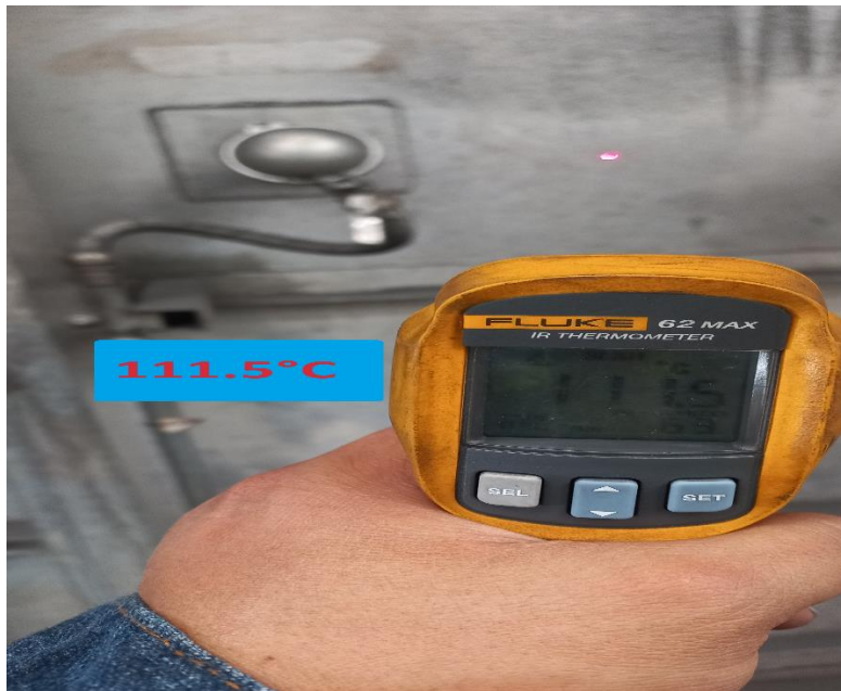
Imagen 12: Temperatura número 6 medida con un pirómetro.
