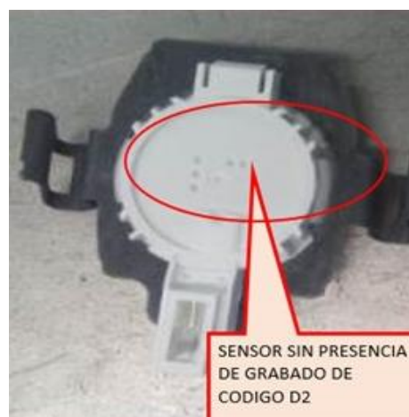
Figura. 10.2. Sensor SBR. [Fuente: S.Q, 2024].
