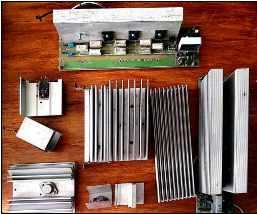
Figura 5.3.1. Tipos de disipadores de aluminio para la refrigeración por aire (Free air).
