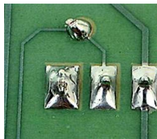
Figura 5.3.7 Técnica de soldadura perfecto.
