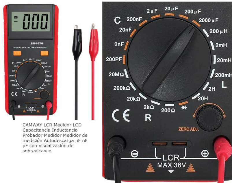
Figura 3.1.8. Multímetro LCR, medición de inductancias y capacitancias.
