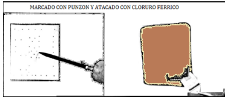
Figura 5.3.3. Punzonado y ataque con cloruro férrico.
