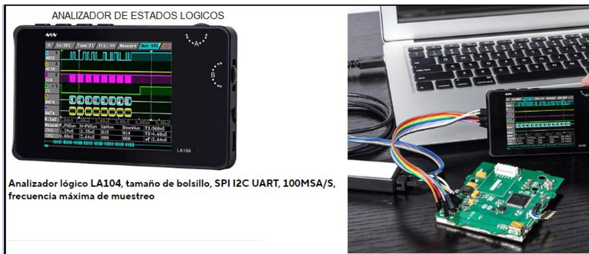
Figura 4.1.2. Analizador de estados lógicos típico y una aplicación [11].
