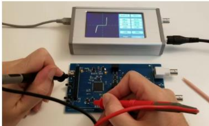
Figura 4.3.9. Trazador de curvas moderno UCE-CT220L.
