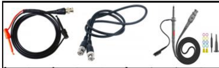
Figura 3.3.3. Puntas de generador, cable de extensión y punta de osciloscopio [11].
