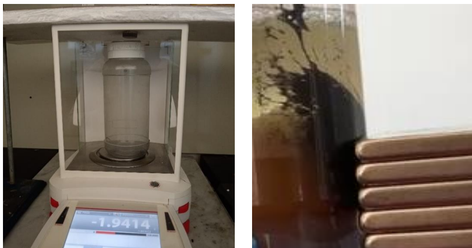
Figura 7. (a) Experimento para medición de su susceptibilidad magnética, (b) Comportamiento del S.M.S. ante la presencia de un campo magnético externo.
