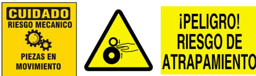
Figura 20. Señalización de la existencia de riesgo mecánico
